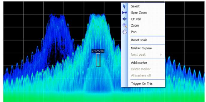
革命性的 DPX® 频谱显示揭示了瞬变信号过程, 帮助您发现不稳定性、毛刺和干扰信号。在这里, 能够清楚看到 3 个信号。两个大信号, 由于出现概率不同, 一个深蓝色, 一个浅蓝色。第三个信号隐藏在中心频率里面, 但是仍然可以被清楚的看到。DPX Density™ 触发, 在存在第三个信号时, 用户可以采集信号进行分析。Trigger On This™ 已被激活, 密度测量框自动被打开, 测得信号密度为 7.275%。任何信号密度大于该测量值的信号都会导致触发事件发生。
