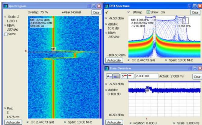
触发和捕获：DPX 密度触发 (DPX Density™) 功能监测频域中的变化，并把任何超限信号捕获到存储器中。三维频谱图 (左窗格) 显示了频率和幅度随时间变化情况。通过在三维频谱图中选择频谱超限触发 DPX 密度™ 触发功能的时点，频域画面 (右窗格) 会自动更新，及时显示该精确时刻的详细频谱视图。
