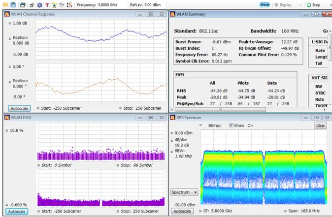
可以选配 802.11 标准分析选项。这里分析了一个 802.11ac 160 MHz 带宽信号，并显示了 EVM 相对于副载波数和符号数关系、通道响应相对于副载波关系及 WLAN 测量摘要、分析的信号的 DPX 频谱。摘要面板可以看到 -44.26 dB 的 EVM 及其它信号测量。
