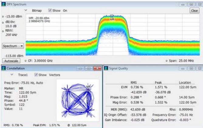
时间相关的多域观测视图使得发现设计或运行问题的能力达到了新的水平，这是使用常规分析解决方案不可能做到的。上图，调制质量和星座测量与 DPX<sup>®</sup> 频谱显示技术的连续监测结合在一起。
