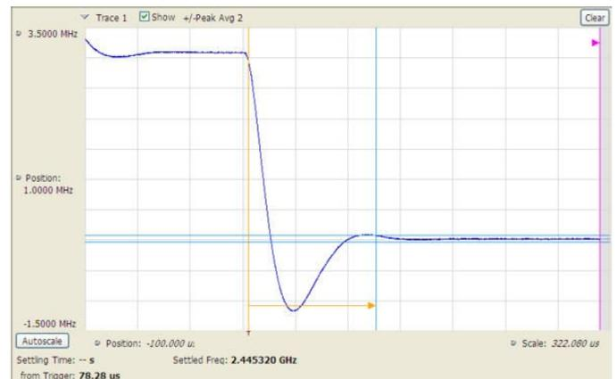
稳定时间测量（选项 12）非常简单且自动完成。用户可以选择测量带宽、容限频段、参考频率（自动或手动），为通过/失败测试稳定最多三个容限频段。稳定时间可以以外部或内部触发做为参考点，也可以从上次稳定频率或相位开始计算。上图通过外部触发测量了振荡器跳频的频率稳定时间。
