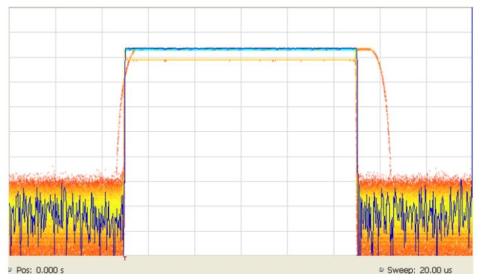
DPX 零频宽（Zero-频宽）实现了幅度、频率、相位对时间的实时分析。高达 50,000 次/秒处理速度。DPX 零频宽（Zero-频宽）保证了时域瞬态信号的发现，减少了调试时间。上图，在时域幅度对时间中捕获了三个不同的脉冲。其中两个波形只是 10,000 个脉冲才出现一次，但是通过 DPX 都能显示和捕获。
