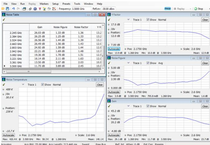
噪声系数和增益测量(选项 14)帮助您使用 RTSA 和噪声源迅速简便地测量您的器件。这个图像显示了测量摘要表及噪声温度、增益、噪声系数和 Y 因数图。
