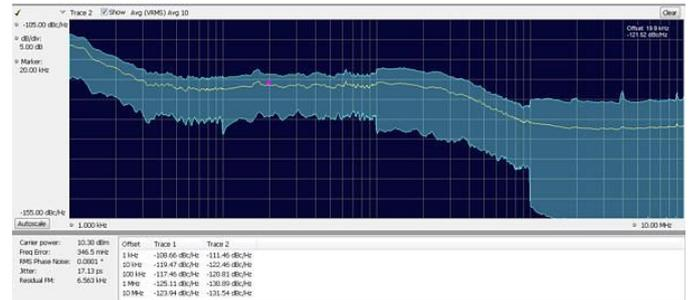
RSA5000 系列上的相位噪声和抖动测量（选项 11）可取代专业相噪测试仪，为您节省测量成本。出色的相噪性能能够满足许多应用需求。上图，在 13 MHz 载频，偏置 10kHz 下相噪为 -119 dBc/Hz，在这个频率，仪器相噪能够达到 -134 dBc/Hz。
