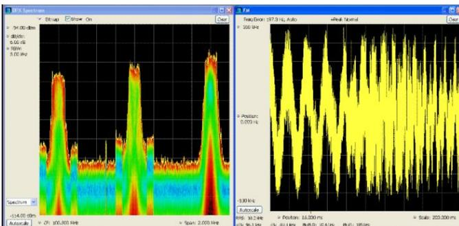
音频监测和调制度测量可以同时并行，使频谱管理更加简便和高效。上图，DPX 频谱显示了关心信号的实时频谱，同时，音频解调结果从内扬声器输出。并且，在图中右中同时得到了 FM 频偏测量结果。
